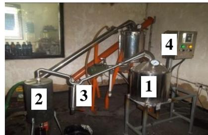
Gambar 1. Alat Reaktor Pirolisis
