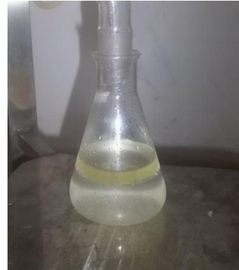
Gambar 3 minyak hasil destilasi tanpa bantuan cooling tower sebagai media pendinginan air.
