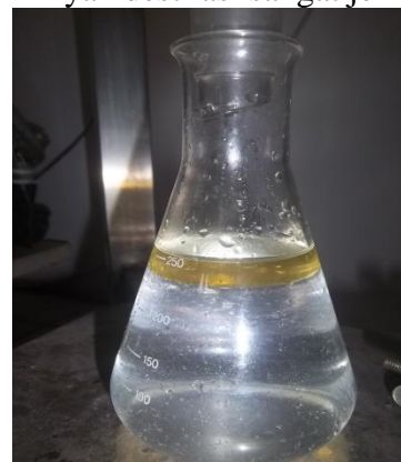
Gambar 4 minyak hasil destilasi dengan bantuan cooling tower sebagai media pendinginan air.
